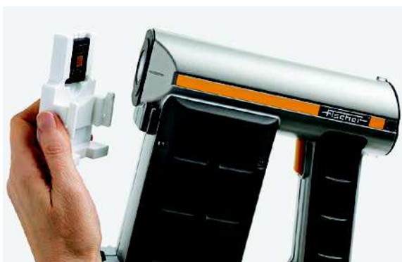
Un pratico supporto posiziona in modo rapido e sicuro gli standard di calibrazione al dispositivo
