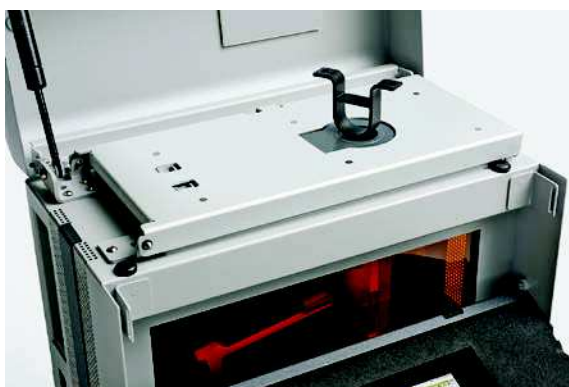
Situato nella sua custodia, l'XAN® 500 diventa uno strumento da banco chiuso - ideale per misure rapide su piccoli oggetti
