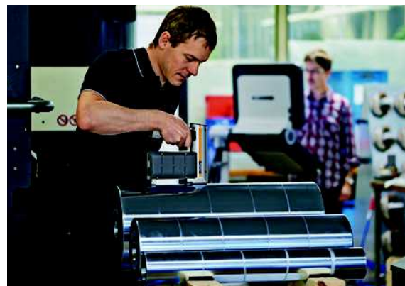
Lo strumento portatile XAN® 500 è ideale per l'utilizzo su oggetti grandi o ingombranti
